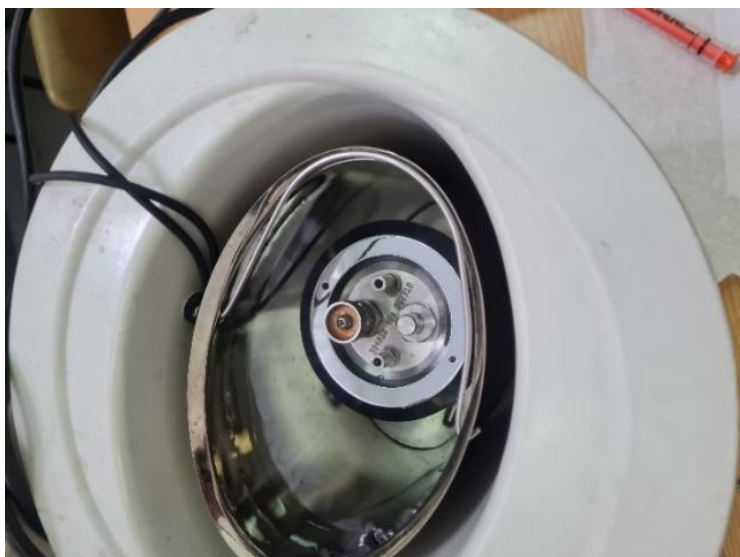
Slika 5.6 Posuda s vodom i kalorimetrijskom bombom
