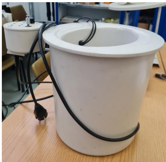
Slika 5.2 Posuda za kalorimetrijsku bombu
