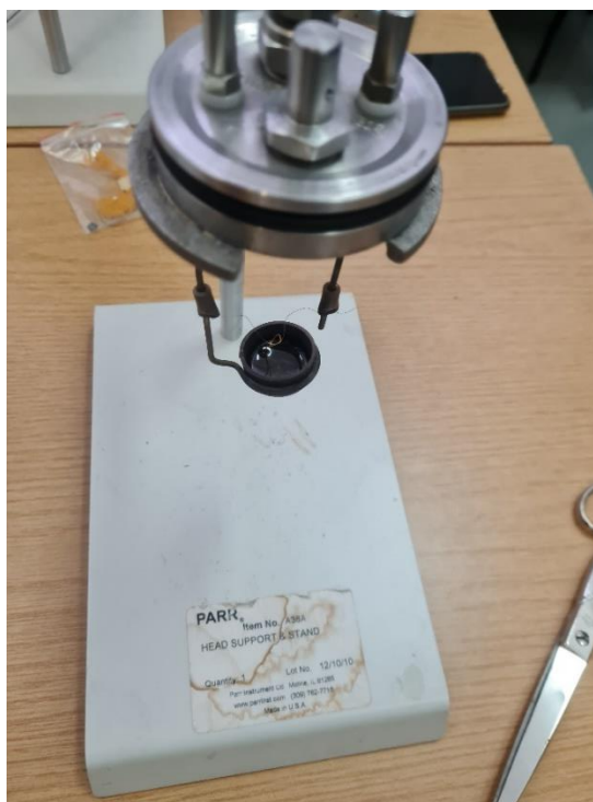
Slika 5.4 Poklopac kalorimetrijske bombe s pripremljenim uzorkom goriva
