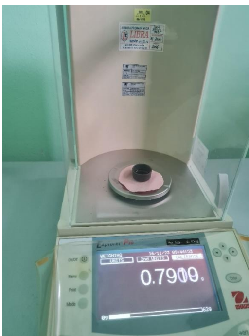
Slika 5.3 Mjerenje mase uzorka goriva
