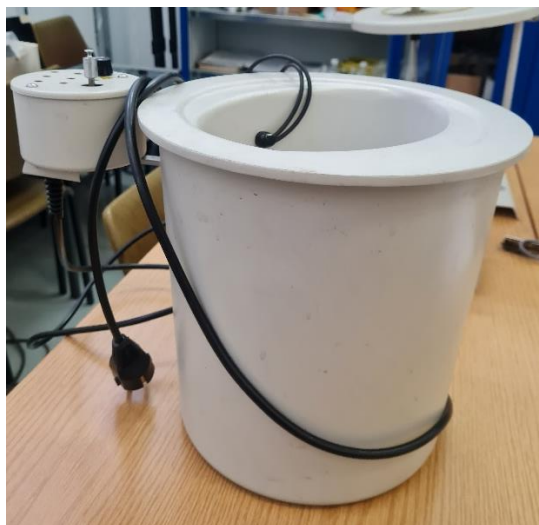
Slika 5.2 Posuda za kalorimetrijsku bombu
