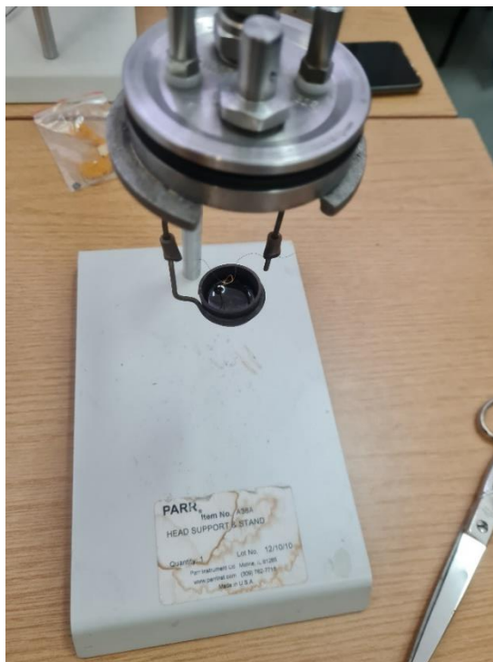
Slika 5.4 Poklopac kalorimetrijske bombe s pripremljenim uzorkom goriva
