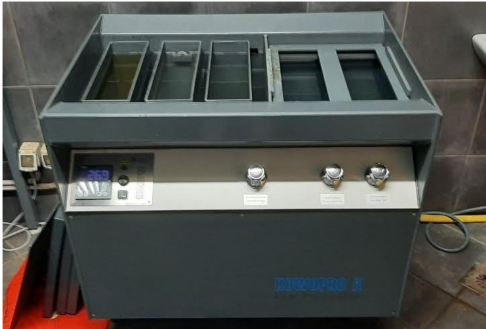
Slika 10.12. Sustav za obradu filma
