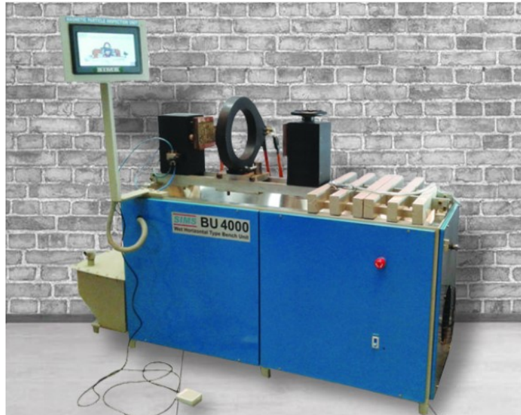
Slika 6.5. Stacionarni stol s opremom za magnetiziranje [30]
