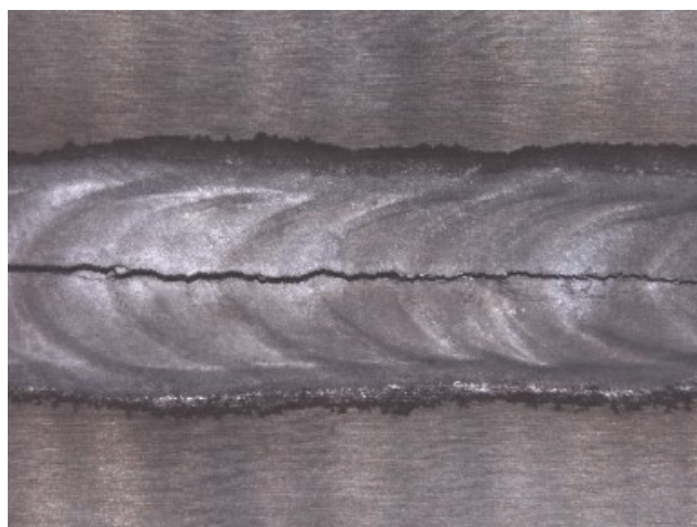
Slika 8.1. Pukotina u zavarenom spoju [41]
