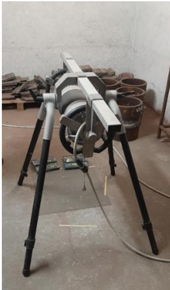
Slika 10.9. Priprema rendgenskog uređaja za ispitivanje
