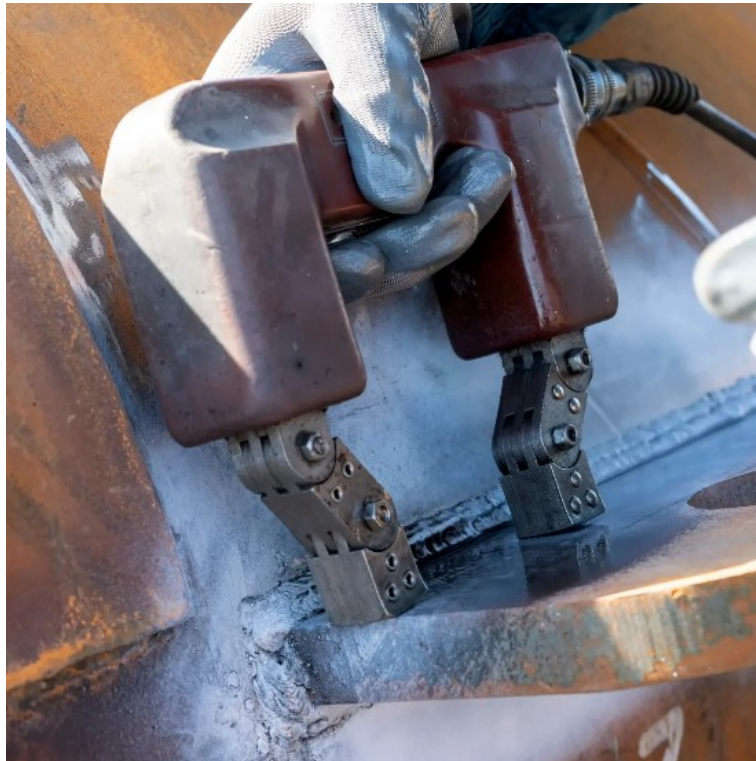
Slika 6.1. Ispitivanje magnetskim česticama [24]
