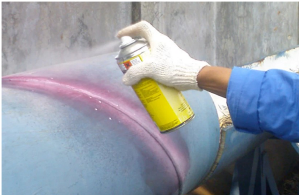
Slika 4.1. Ispitivanje tekućim penetrantima [10]
