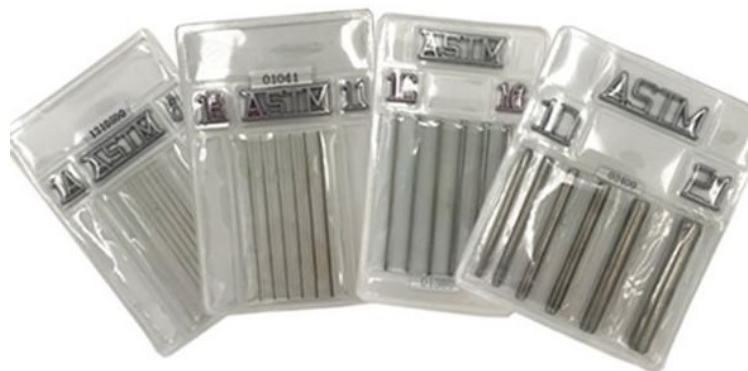
Slika 10.5. Žičani indikator kvalitete radiograma [51]
