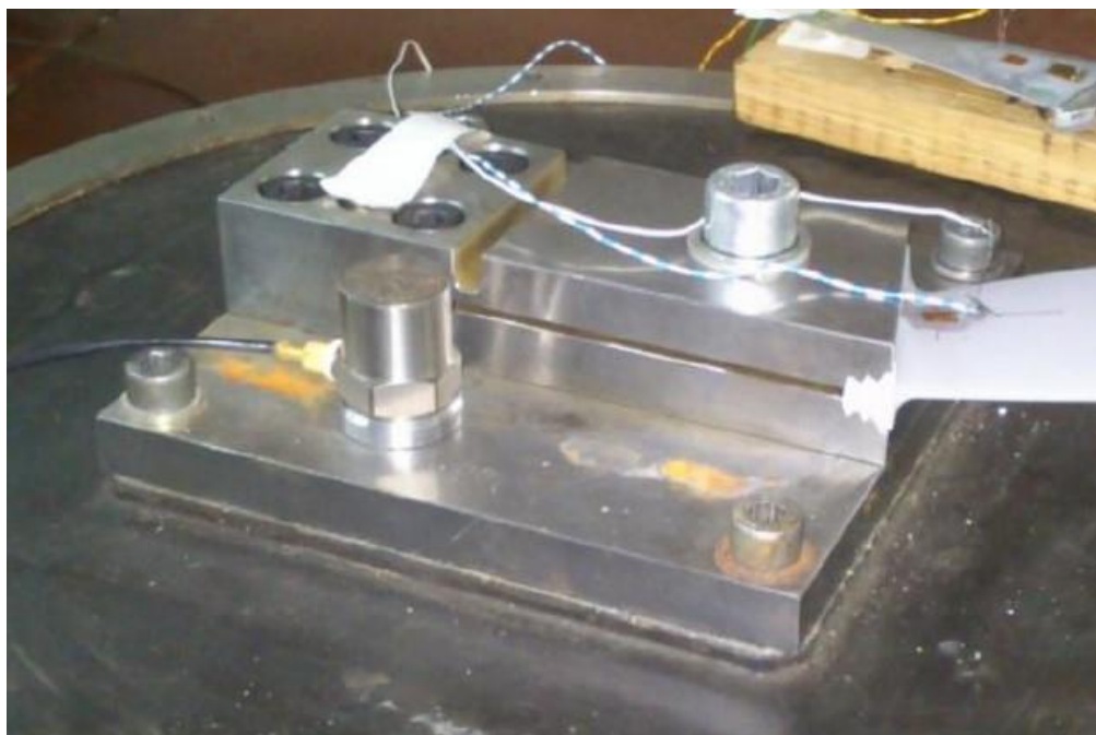
Slika 4.3 Princip osiguranja lopatice u eksperimentalnom ispitivanju
