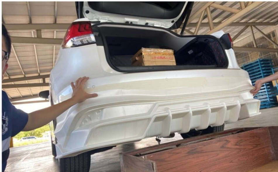
Slika 2.4. Prototip automobilskog branika
