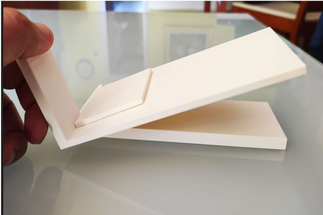
Slika 4.7. Finalno stanje ispitivanja trenja
