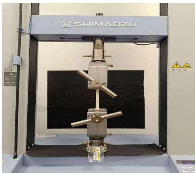
Slika 4.2. Epruveta u kidalici
