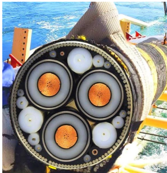
Slika 4.1 Reprezentacija podvodnog kabela [24]
