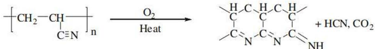
Slika 3.17 Kemijski spoj poliakrilonitrila kao osnovne sirovine za proizvodnju karbonskih vlakana [12]
