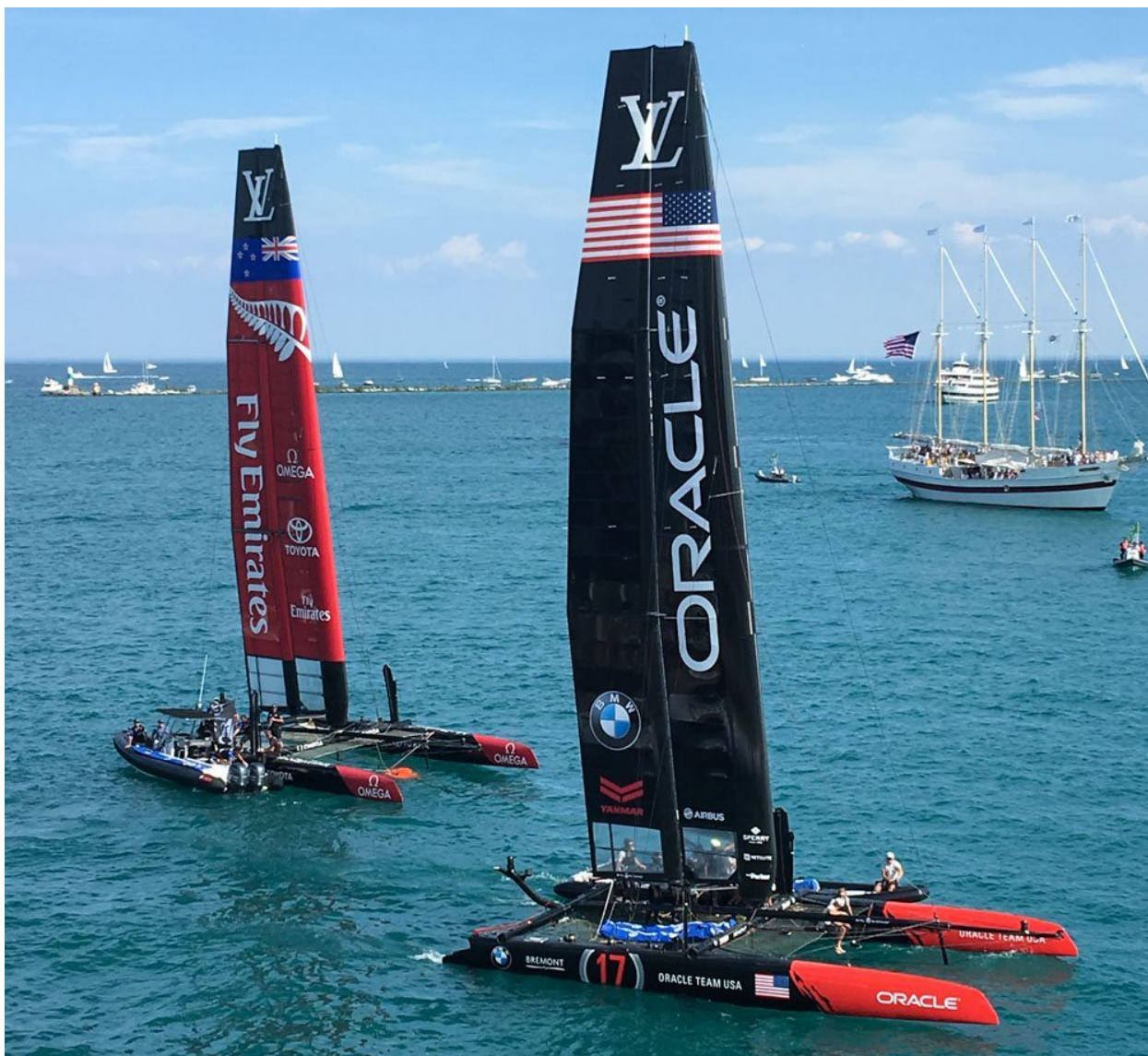
Slika 3.15 Katamaran (AC45) sa krutim jedrom i jarbolom od ugljičnih vlakana (Izvor: https://www.ablogtowatch.com/bremont-watches-sailing-oracle-team-usa-ac45-america-cup-boat/ )
