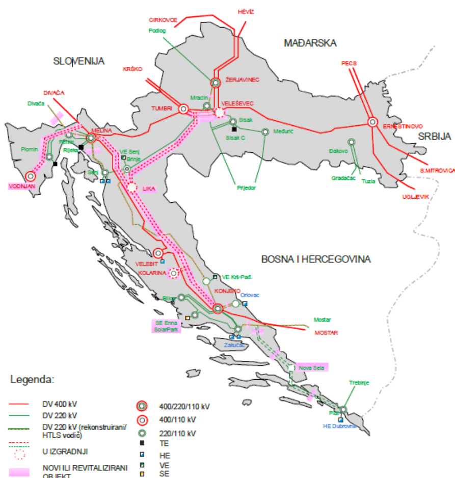
Slika 2.3. Prikaz konfiguracije prijenosne mreže krajem 2032. godine [9]
