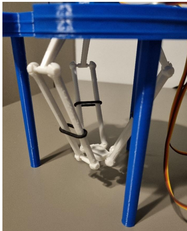
Slika 4.5.3-bočni prikaz sastavljenog Delta robota (lijevo) i maksimalno „ispružena“ ruka (desno)
