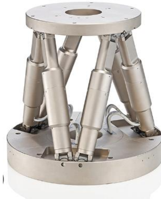
Slika 2.1.1. Primjer Stewartove platforme [10]
