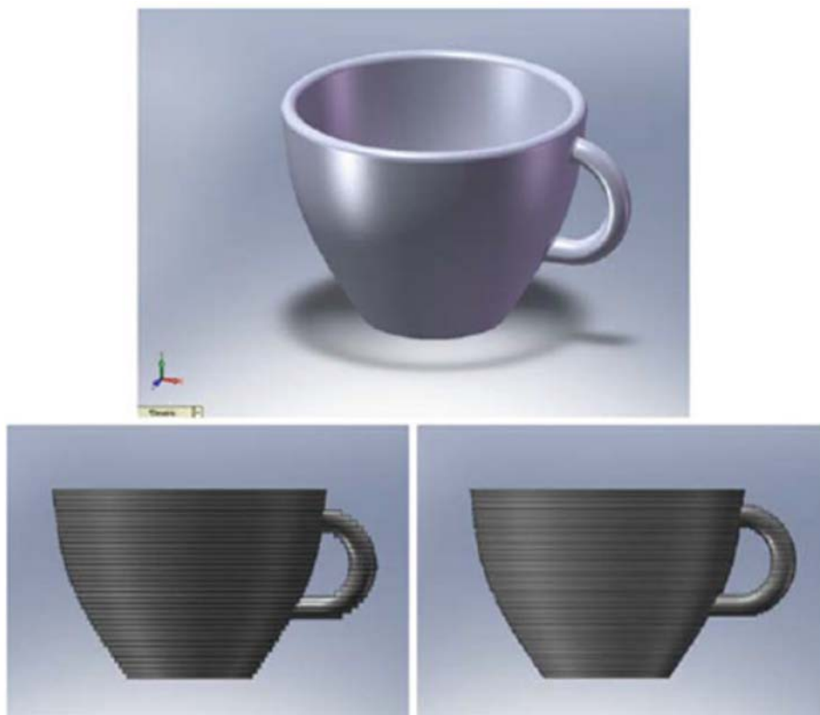
Slika 2.8. CAD slika šalice za čaj s dodatnim slikama koje prikazuju učinke izrade korištenjem različitih debljina slojeva [9]
