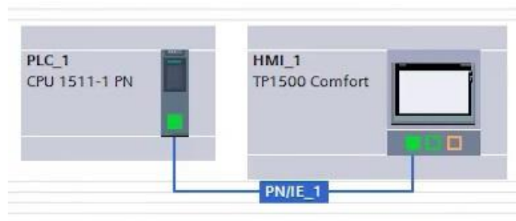
Slika 2. Odabrani PLC i HMI
