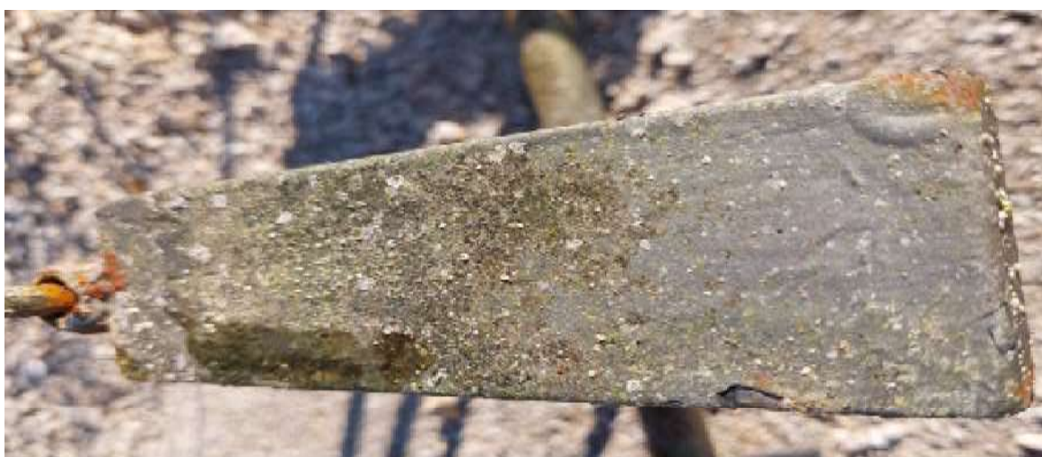
Slika 5.24 Uzorak sa završnom organskom bojom (bez međupremaza)
