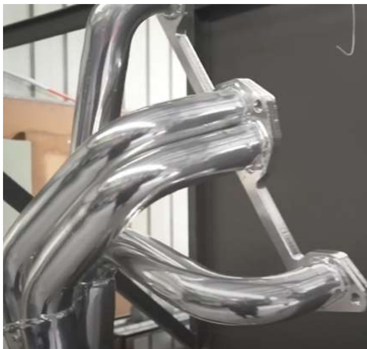
Slika 4.19 Cijev nakon poliranja [21]
