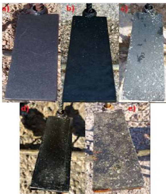
Slika 5.33 Uzorak 5 a) prije uranjanja, b) prvi pregled, c) drugi pregled, d) treći pregled, e) četvrti pregled
