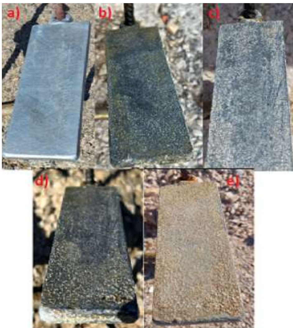
Slika 5.29 Uzorak 1 a) prije uranjanja, b) prvi pregled, c) drugi pregled, d) treći pregled, e) četvrti pregled
