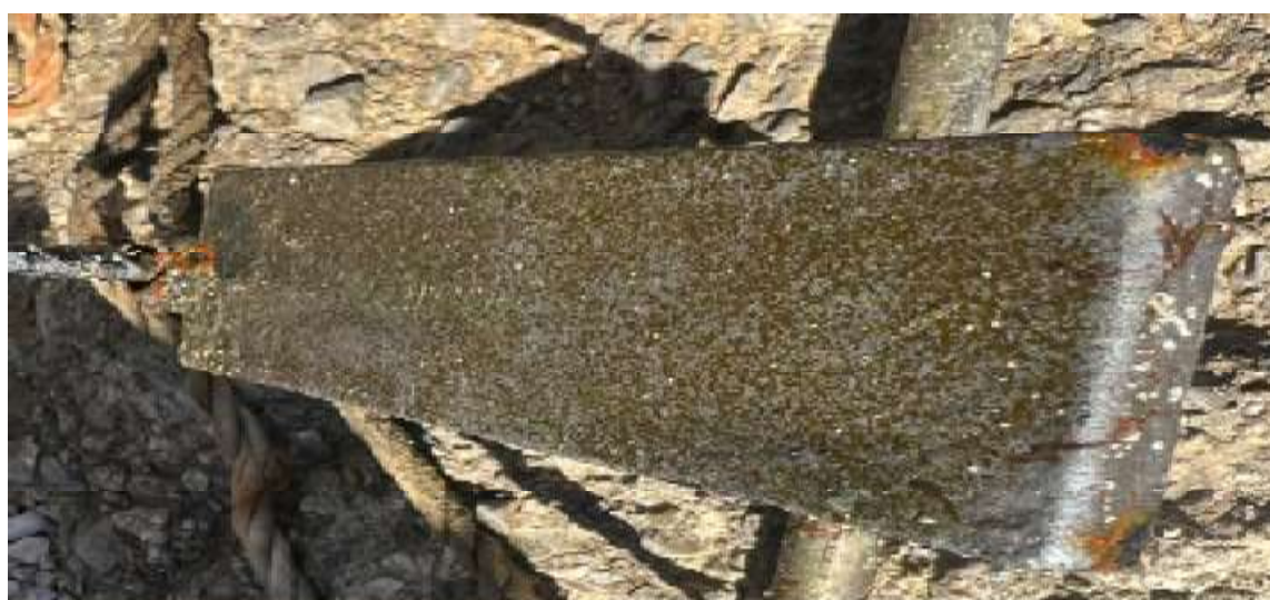
Slika 5.18 Uzorak sa završnom organskom bojom (bez međupremaza)
