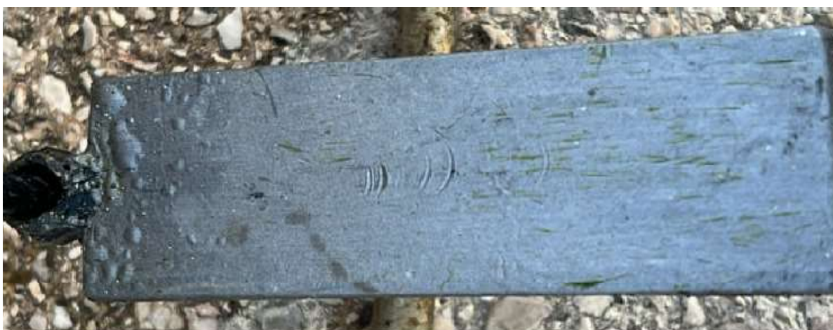
Slika 5.6 Uzorak sa završnom organskom bojom (bez međupremaza)
