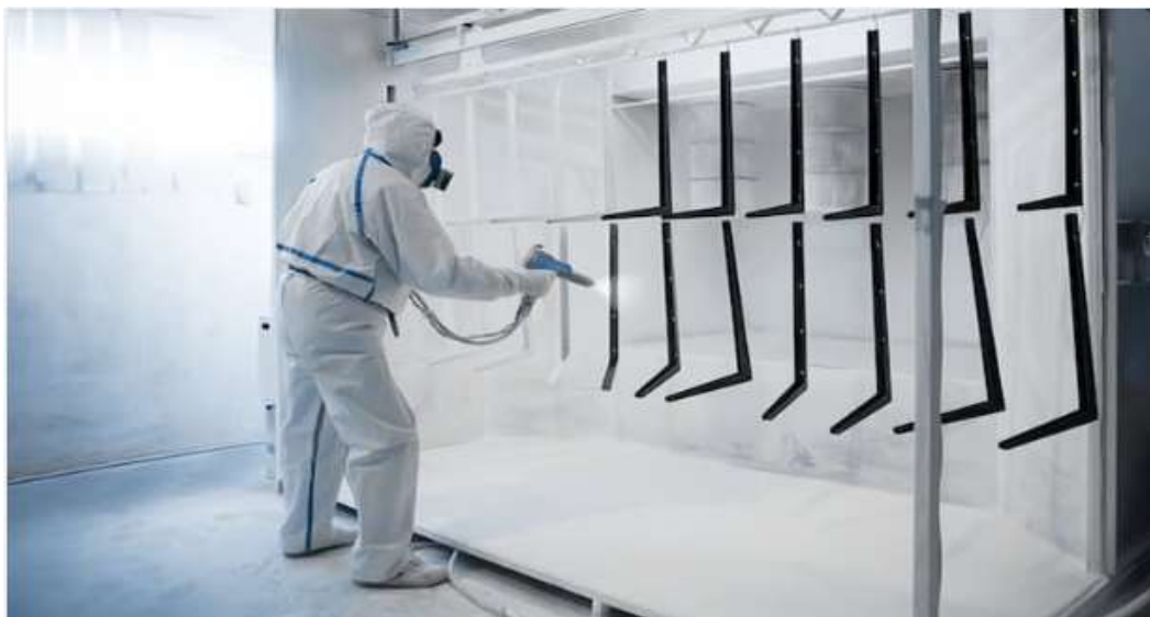
Slika 4.20 Nanošenje praha na metal [22]
