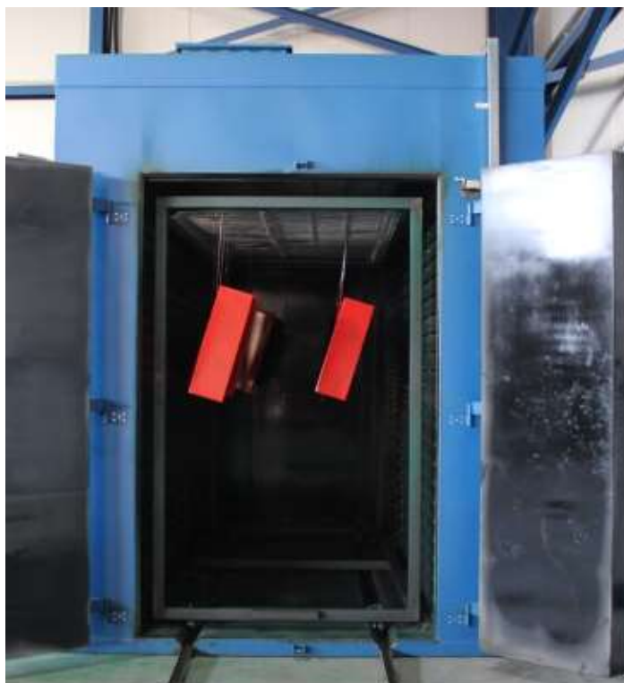
Slika 4.21 Polimerizacija na visokim temperaturama [23]
