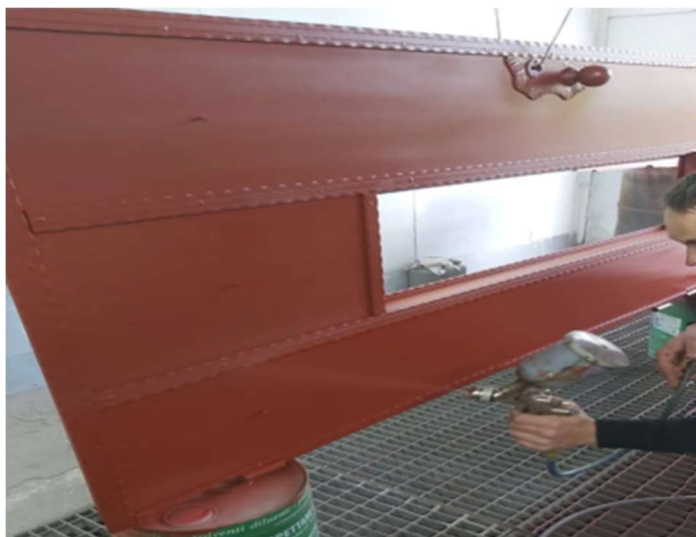
Slika 4.26 Nanošenje boje pištoljem na komprimirani zrak [19]
