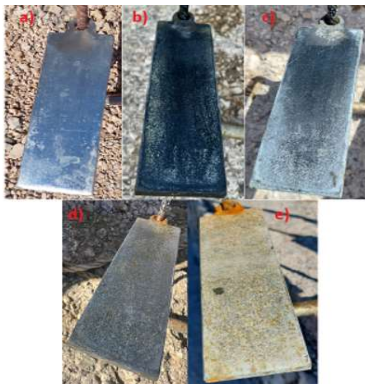
Slika 5.34 Uzorak 6 a) prije uranjanja, b) prvi pregled, c) drugi pregled, d) treći pregled, e) četvrti pregled
