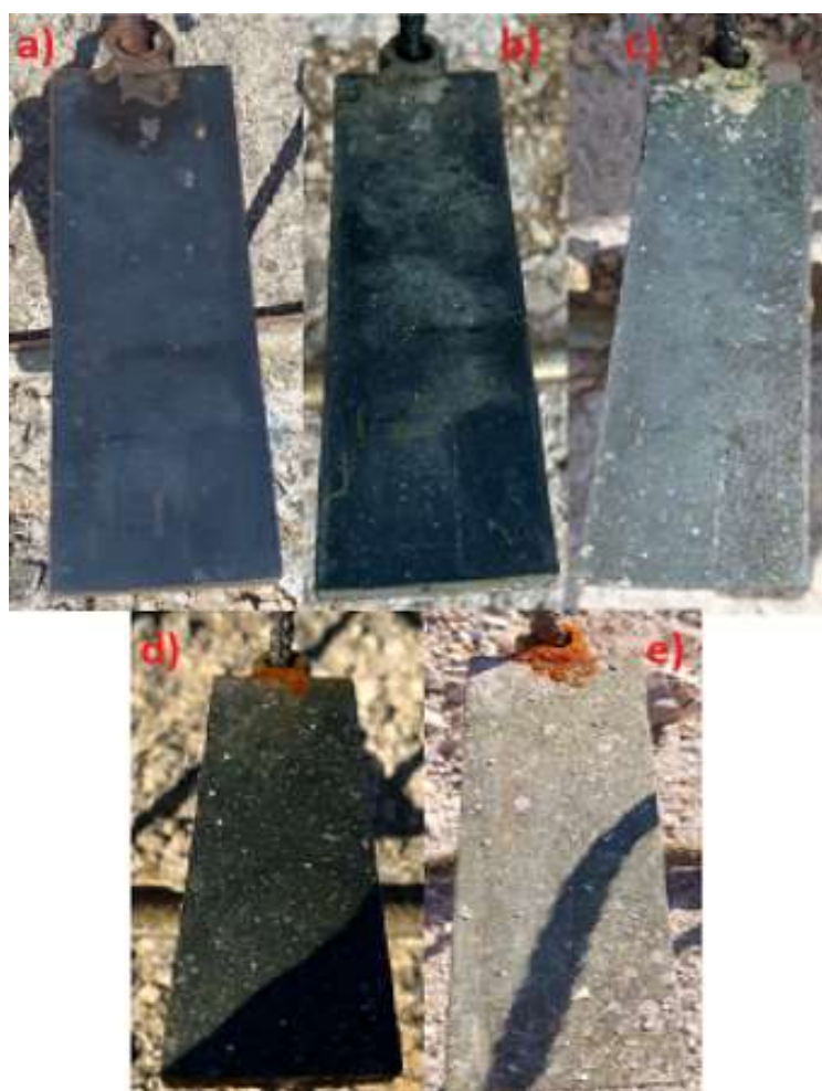
Slika 5.32 Uzorak 4 a) prije uranjanja, b) prvi pregled, c) drugi pregled, d) treći pregled, e) četvrti pregled
