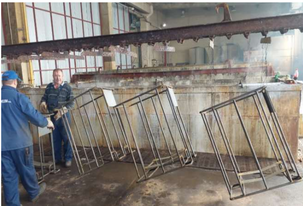
Slika 4.4 Kut pod kojim se uranja materijal u posude
