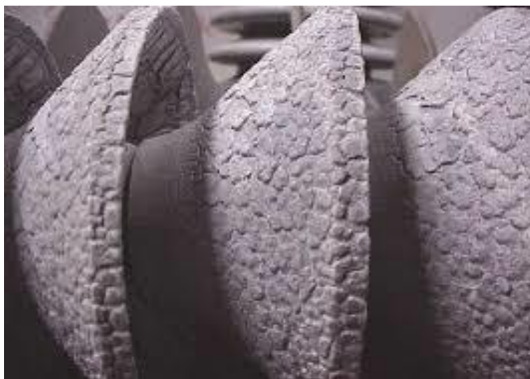
Slika 5.10. Aligatoring površine polimernog izolatora[13]
