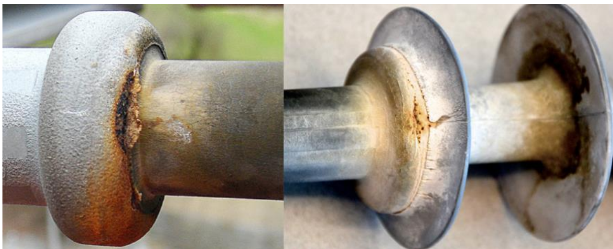
Slika 5.12. Erozijska površina uzrokovana koronarnim efektom[12]
