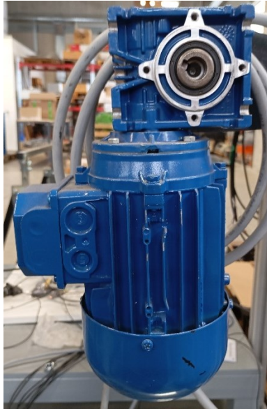
Slika 3.12. Reduktor spojen na asinkroni motor.
