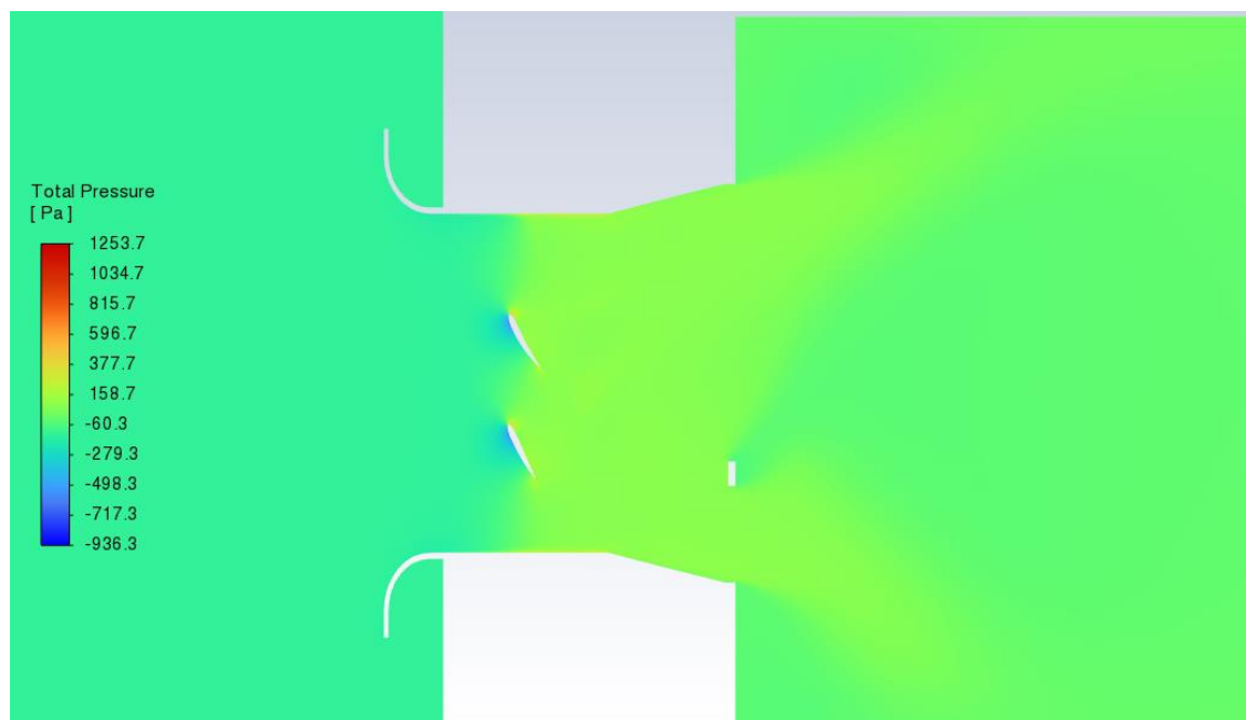
Slika 6.4 Kontura totalnog tlaka na ravnini X = 0
