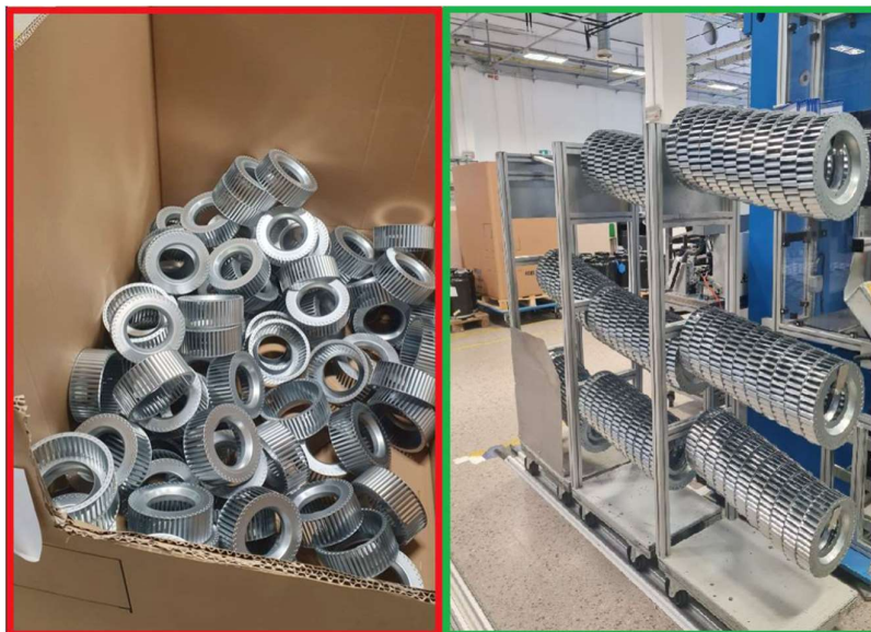
Slika 4.4: Nepravilno i pravilno skladištenje poluproizvoda
