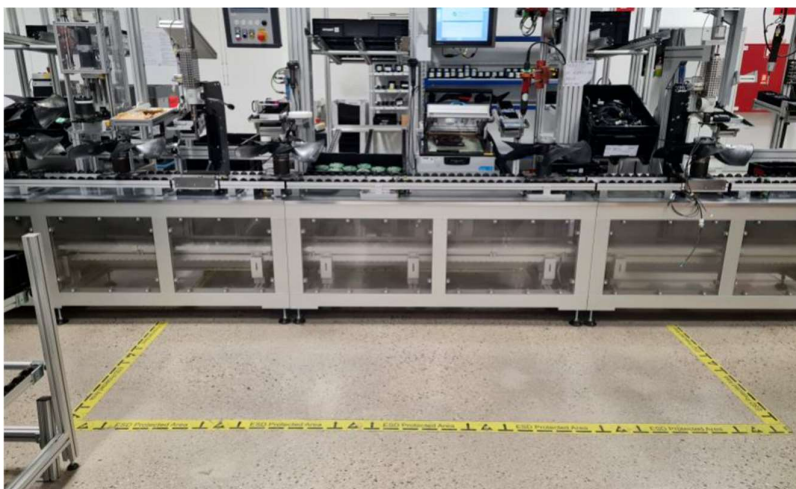
Slika 4.3: Primjer podne oznake gdje je potrebna upotreba antistatičke zaštite
