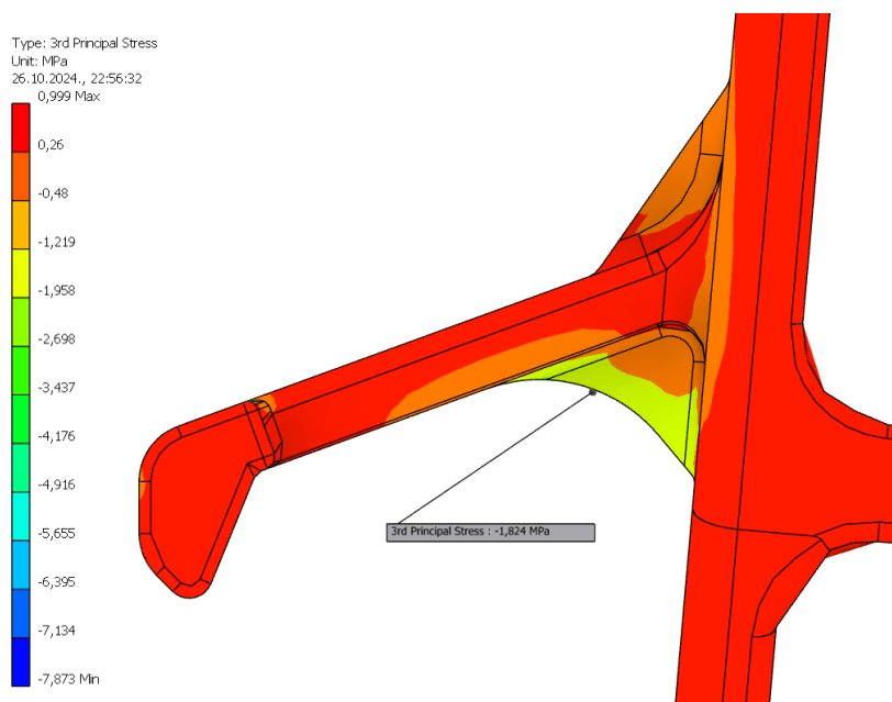
Slika 5.54 Treća glavna naprezanja na pomoćnoj kuki
