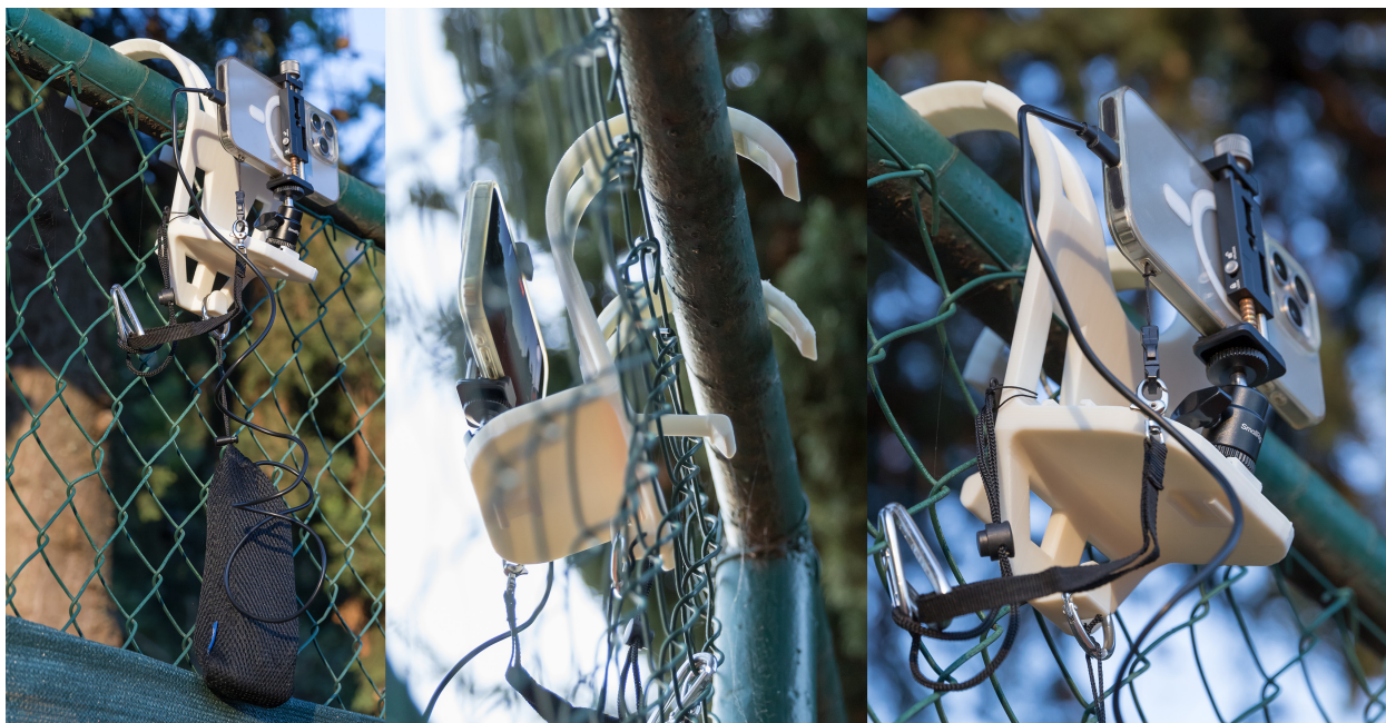
Slika 7.3 Nosač montiran na poprečnu cijev ograde igrališta
