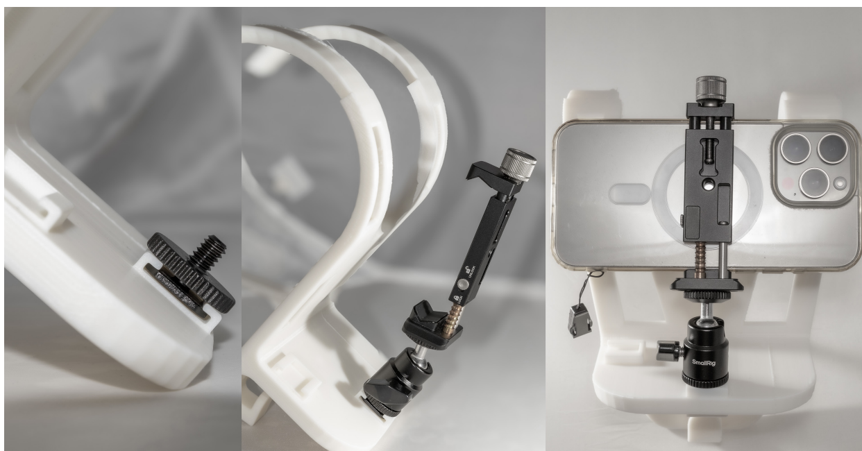
Slika 7.2 Koraci montiranja pametnog telefona na nosač
