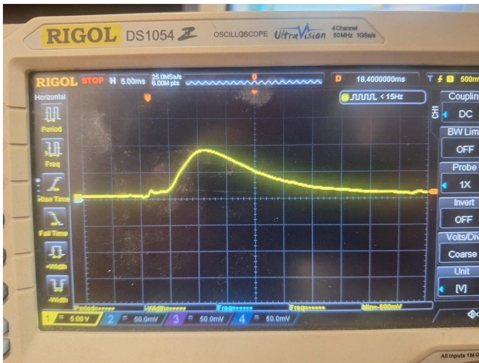
Slika 7.2 Signal piezoelektričnog senzora tlaka
